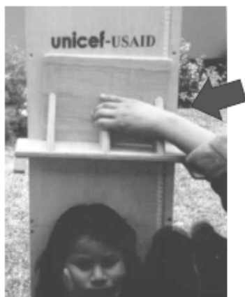
Figura 34: Tope móvil en posición incorrecta
