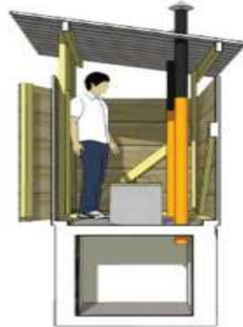
Letrina lavable conectada a tanque séptico
